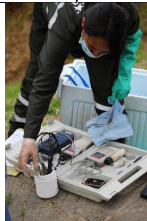
Fotografía 19. Proceso de medición pH, conductividad, temperatura ambiente y muestra, OD y posicionamiento global. Coordenadas 4°31'31.96"N -74°07'36.17"W
