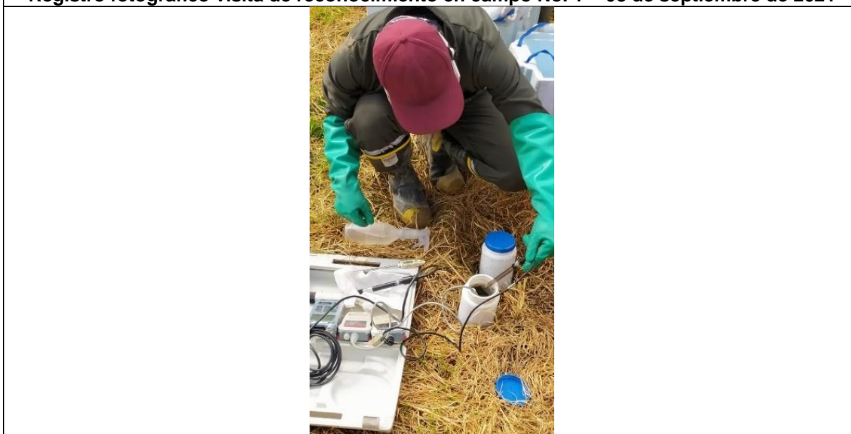
Fotografía 32. Medición In Situ de parámetros de calidad de agua de los lixiviados vertidos al cauce del Río Tunjuelo, se observa claramente el color pardo oscuro-negro de los mismos justo en el punto de descarga.
